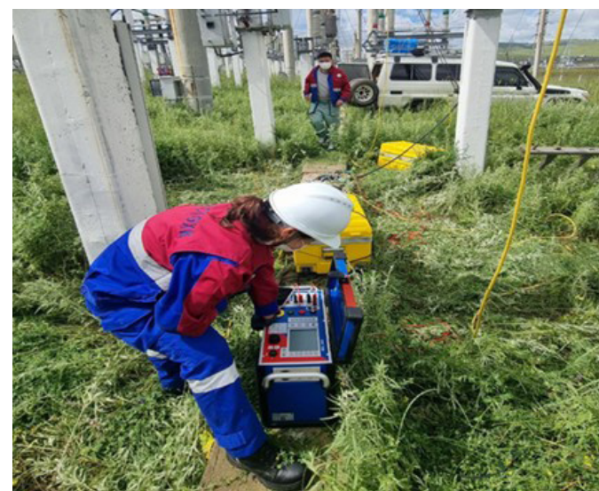
OMICRON CPC-100 маркийн ЦДАШ-ын бодит эсэргүүцлийг хэмжих багажаар хэмжилт хийж байна
